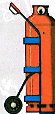
(9)移动气体钢瓶使用手推车,切勿拖拉、滚动或滑动气体钢瓶。严禁敲击、碰撞气体钢瓶。
