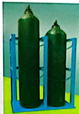
(7)开启钢瓶时,先开总阀,后开减压阀。关闭钢瓶时,先关总阀,放尽余气后,再关减压阀。切不可只关减压阀,不关总阀。
